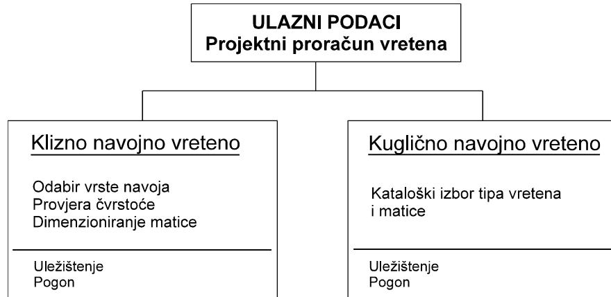
**Slika 8.1: Shematski prikaz procesa projektiranja navojnih vretera**
