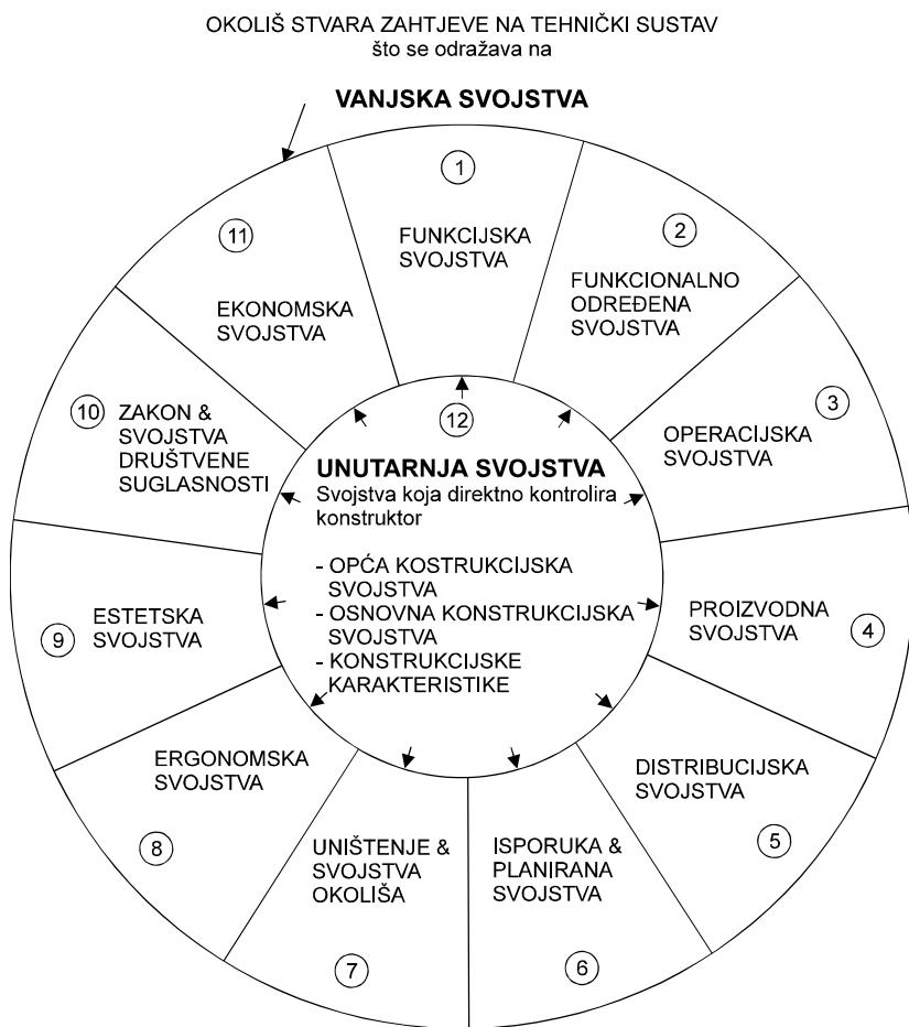
**Slika 3.3: Odnosi među osobinama unutar tehničkog sustava**
