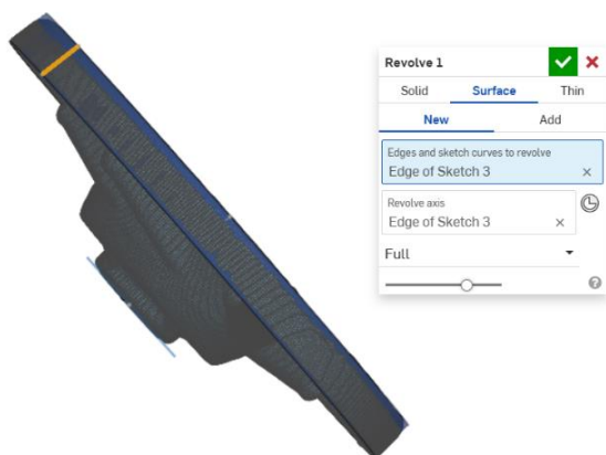
Slika 209. Izrada prve površine alatom Revolve
