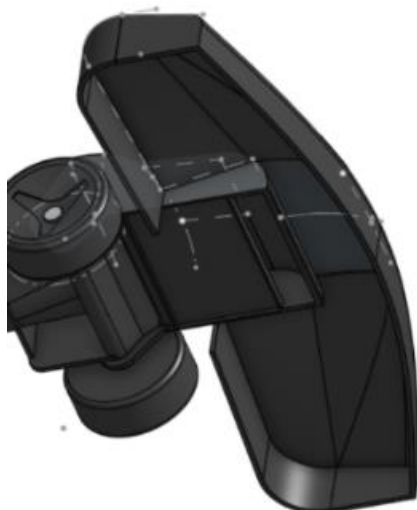
Slika 136. Stvaranje krutog tijela alatom Thicken
