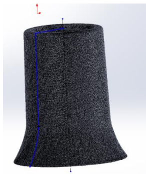
Slika 879. Skica za Revolved surface za izradu otvora na vanjskoj površini baze, se kreira skica otvora u nekoj ravni koja se projicira na površinu baze.
