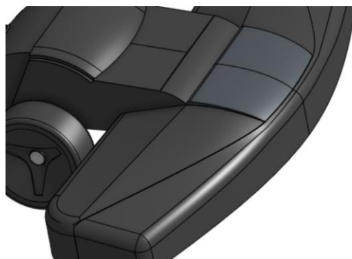
Slika 1106. Zaobljenja na vanjskim rubovima nastavka
