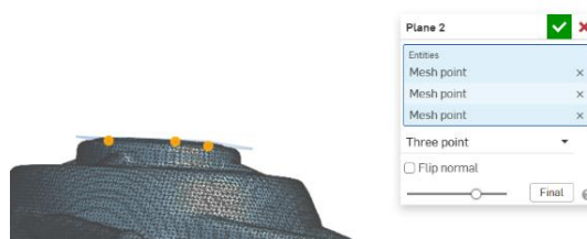
Slika 206. Postavljanje prve ravnine
