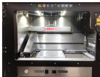
Unutrašnjost otvorene komore printera EOS M 290
