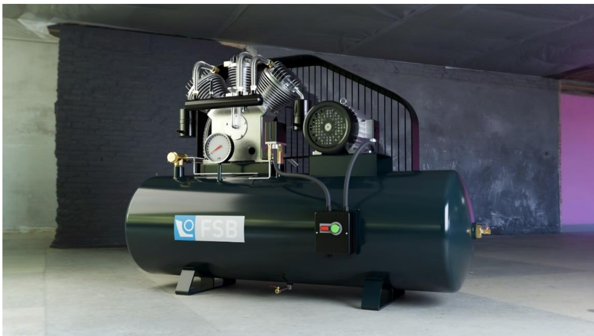
Slika 55. Render CAD modela kompresora za zrak
