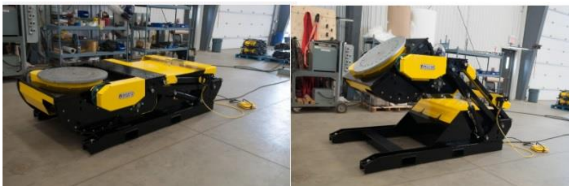
Slika 2.7. Hidraulička naprava za pozicioniranje tvrtke Welding Automation [8]
