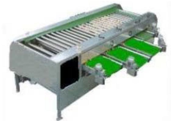
Slika 3.2.3a. Stroj za razvrstavanje povrća Global-agritech
