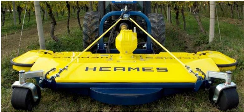
Slika 7. *Hermes malčer* – strojni nastavak za *malčiranje* sa montiranjem na prednjem dijelu traktora
