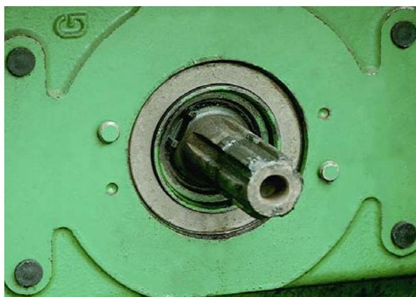
Slika 19. Izlaz radnog vratila na traktoru
