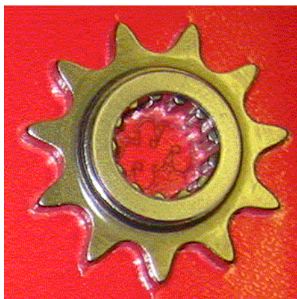
Slika 5.2. Manji (pogonski) lančanik 11 , z=11 zubi.
