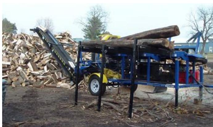
Slika 8 Stroj za obradu ogrjevnog drva Dyna SC – 14
