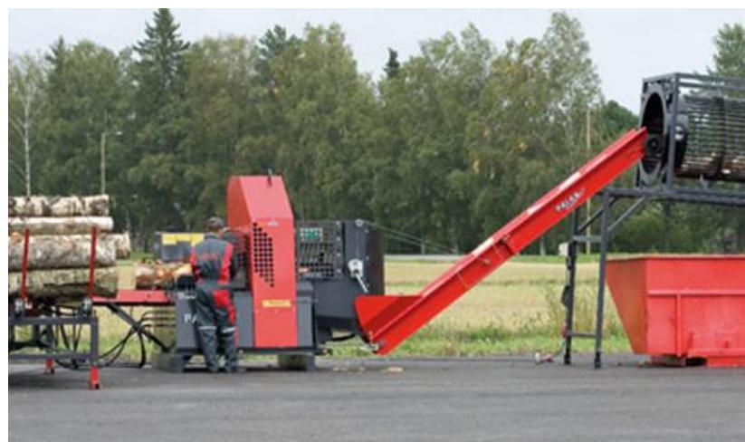
**Slika 6 Stroj za obradu ogrjevnog drva Palax Power 100 S**
