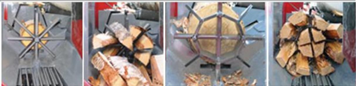
Slika 12 Klinovi za cijepanje na 8 i 12 dijelova
