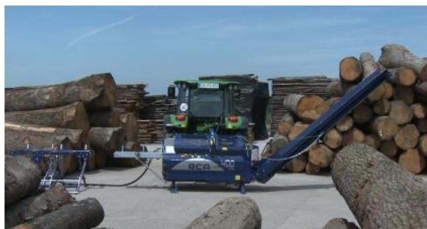
**Slika 5      Stroj za obradu ogrjevnog drva RCA 400 joy**
