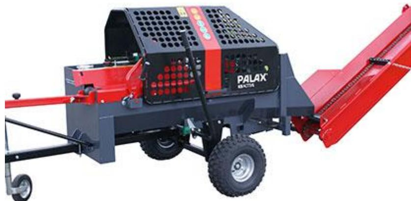
**Slika 7      Stroj za obradu ogrjevnog drva Palax Active**
