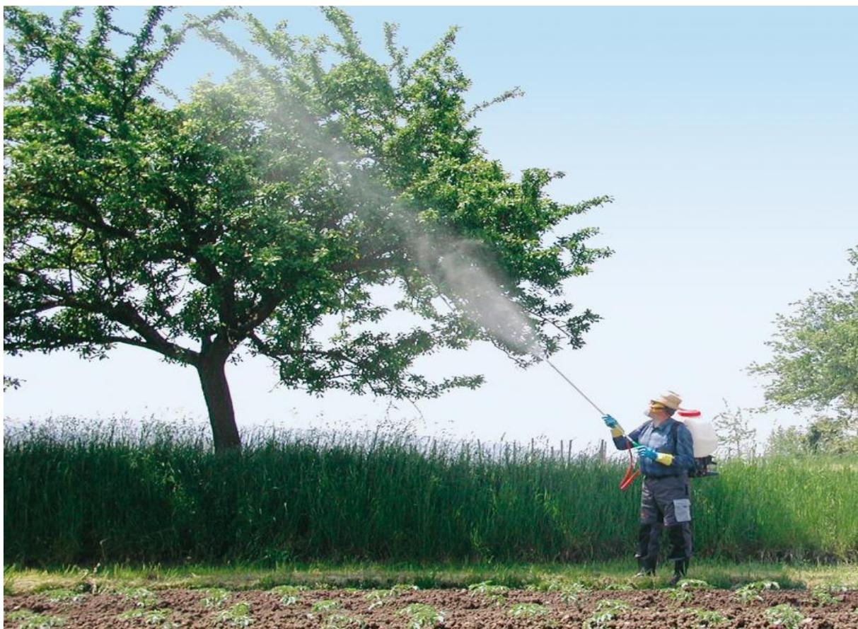
**Slika 2. Visokotlačna motorna prskalica**
