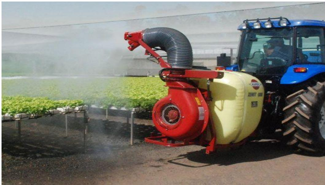
**Slika 14. Izvedba atomizera s turbinom**
