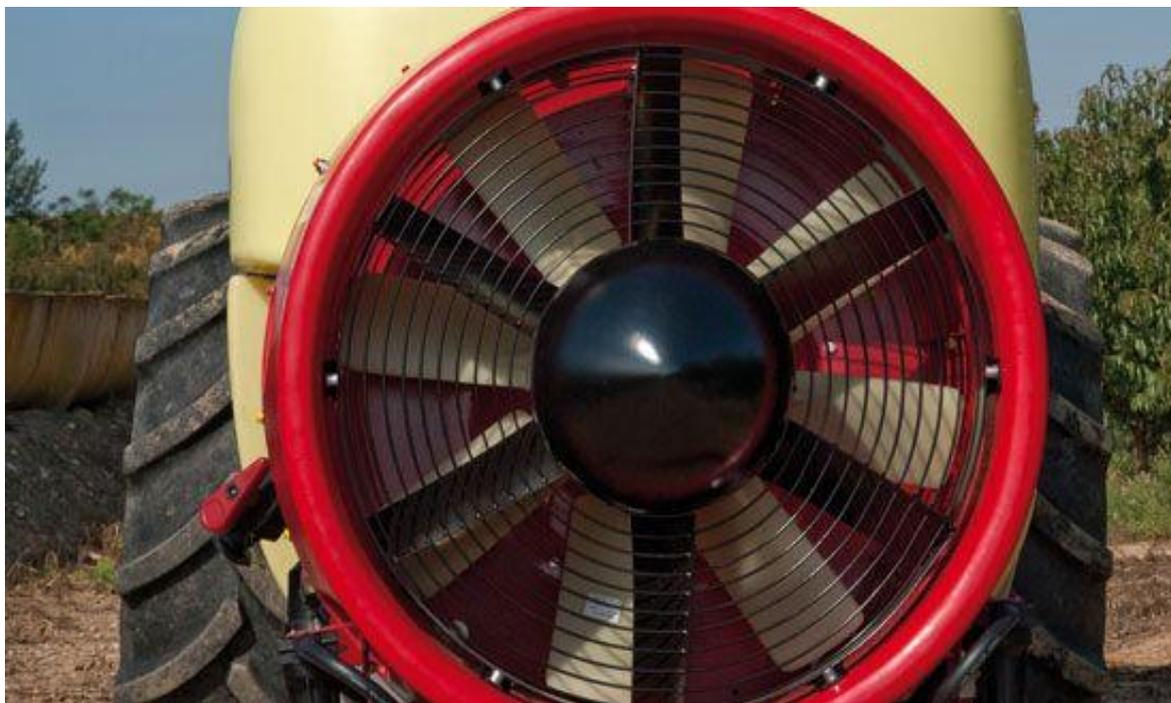
**Slika 15. Izvedba atomizera s ventilatorom [8]**
