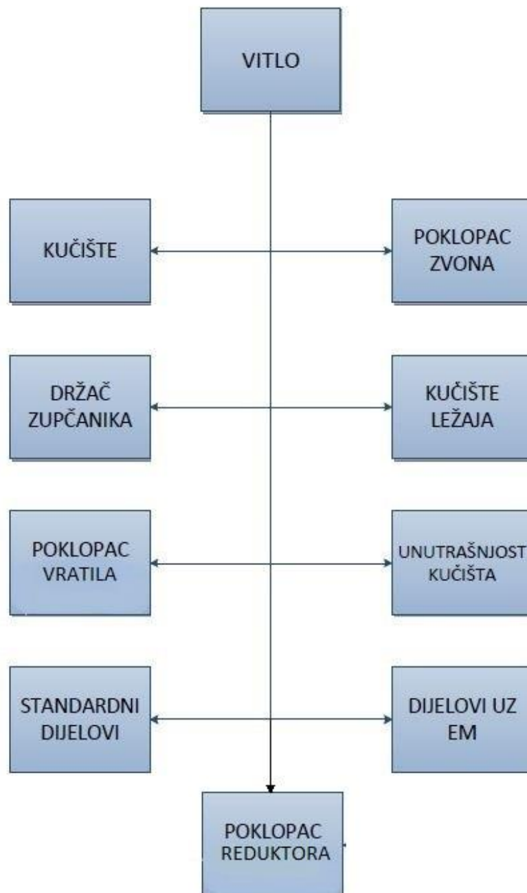
Slika 25 Shema podsklopova vitla čiji su dijelovi uneseni u analizu
