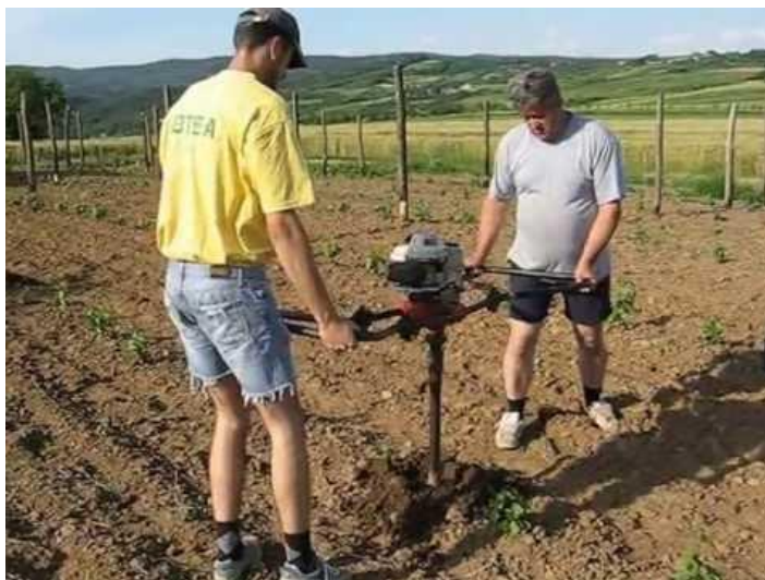
Slika 3. Mehanizirano ručno bušenje
