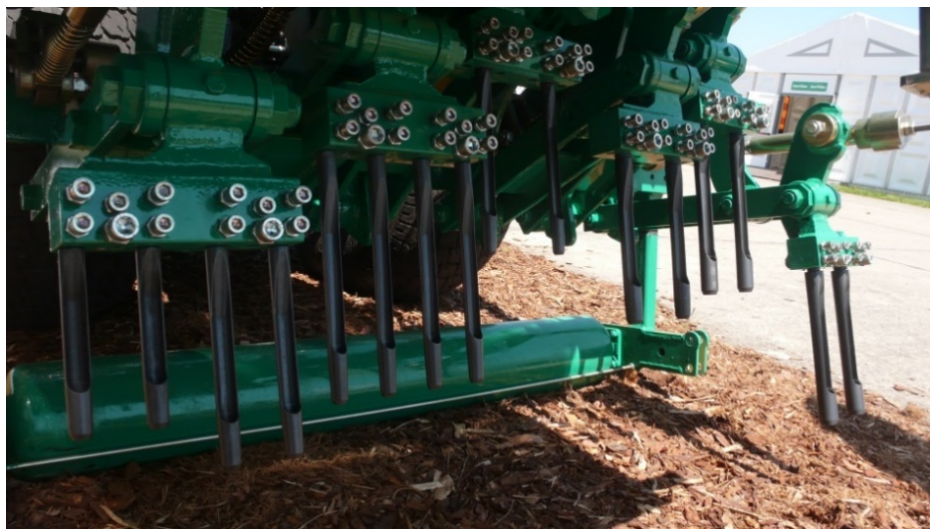
Slika 19. Glava sa zubima prozračivača AEROKING 300.80 [20]
