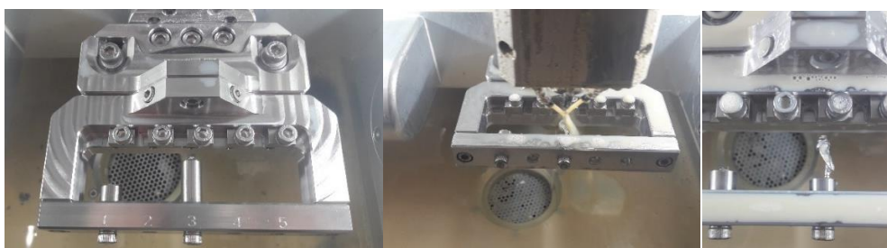
Slika 43. Predobradak stegnut u zahvatu prije početka obrade glodanjem (lijevo), tijekom glodanja (sredina) i nakon završetka obrade (desno)
