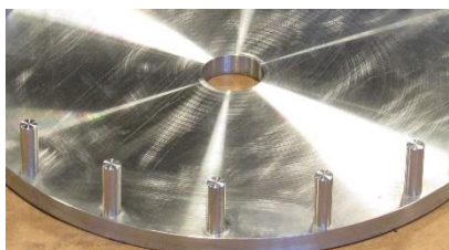
Slika 14. Rotor s zaticima
