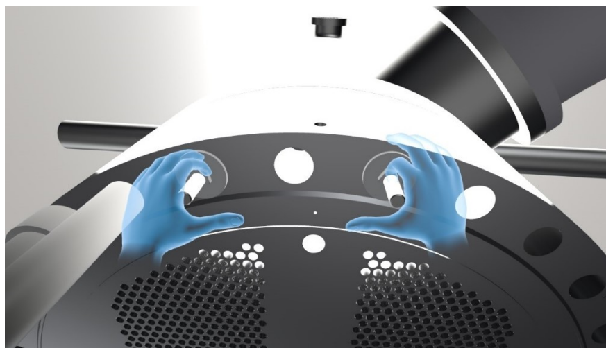
Slika 95. Postavljanje polimernih vijaka
