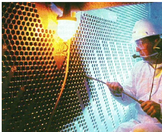
Slika 7. Ručno ispitivanje cijevne stijene [10]
