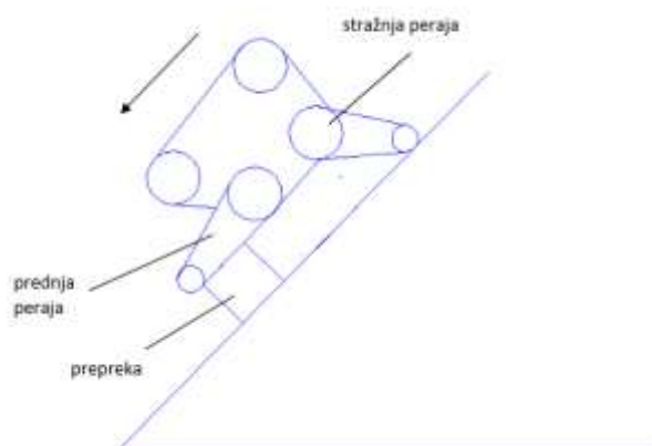
Slika 43. Savladavanje prepreke na putu pomoću prednje peraje
