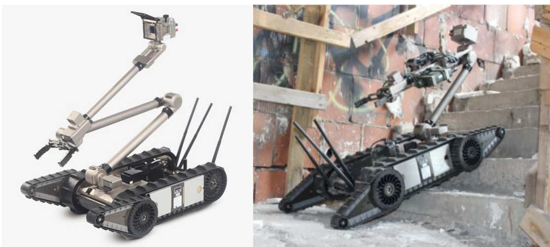
Slika 2.2. Packbot bez i sa stražnjim „gusjenicama“
