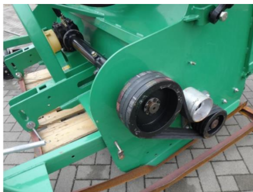
Slika 60. Remenski prijenos na modelu FLP 180 [34]
