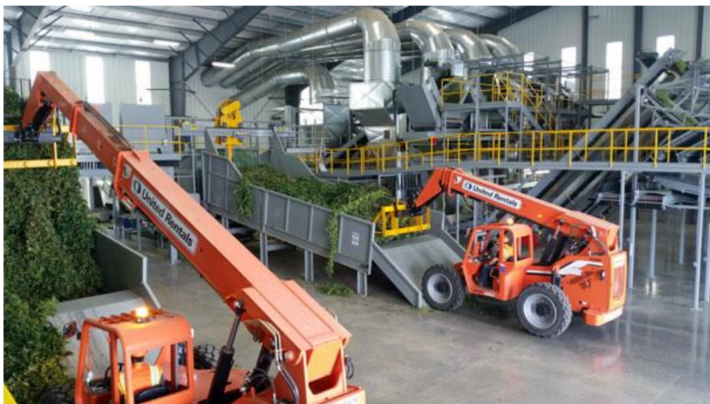
Slika 13. Pogon za odvajanje ploda od stabljike [35]
