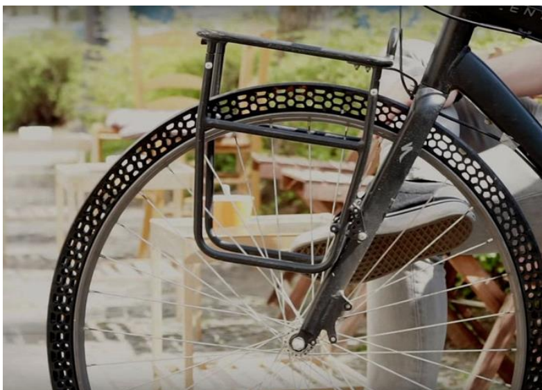
Slika 16 BigRep bez zračna guma
