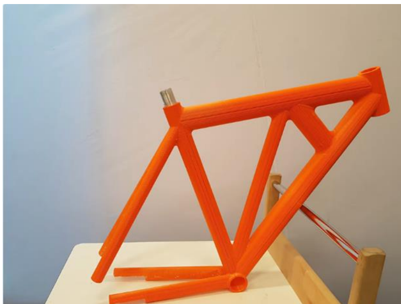
Slika 10 Rama bicikla napravljenog na Sveučilištu u Aalborgu
