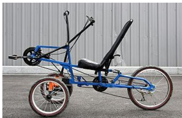
**Slika 2.7** Izvedba sa ručnim i nožnim pogonom
