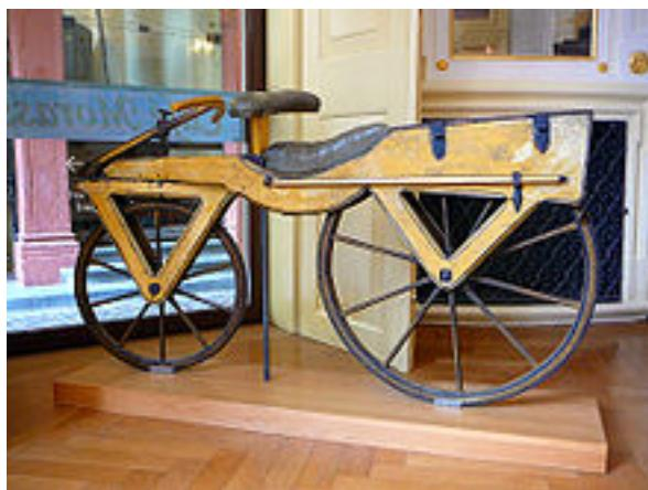
Slika 2.2 Preteča modernog bicikla, *Laufmaschine*.
