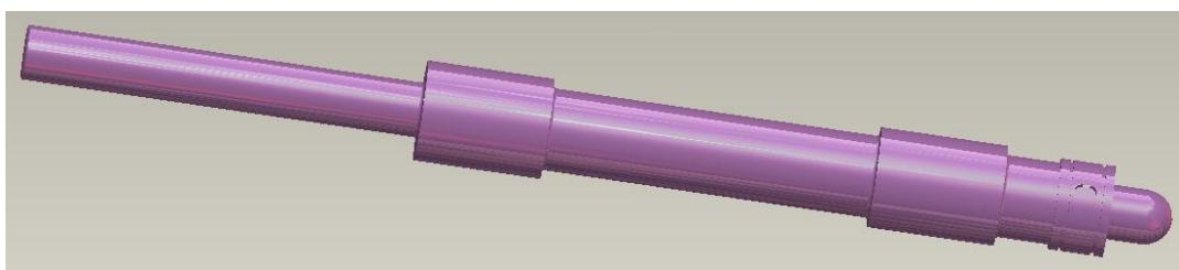
Slika 55: Konačni izgled vratila podizača
