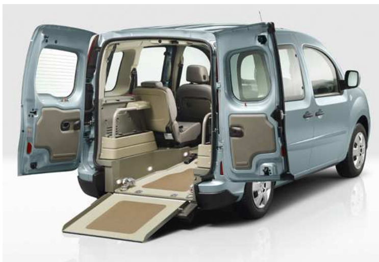
Slika 3. Vozilo prilagođeno ulasku osoba u invalidskim kolicima
