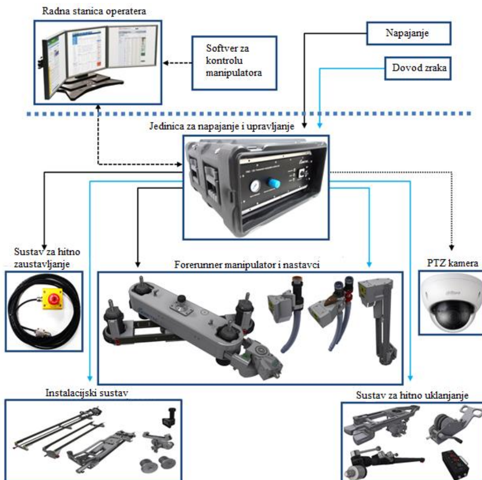
Slika 12. Forerunner inspeksijski sustav tvrtke INETEC za generatore pare nuklearnih elektrana PWR tipa [11]
